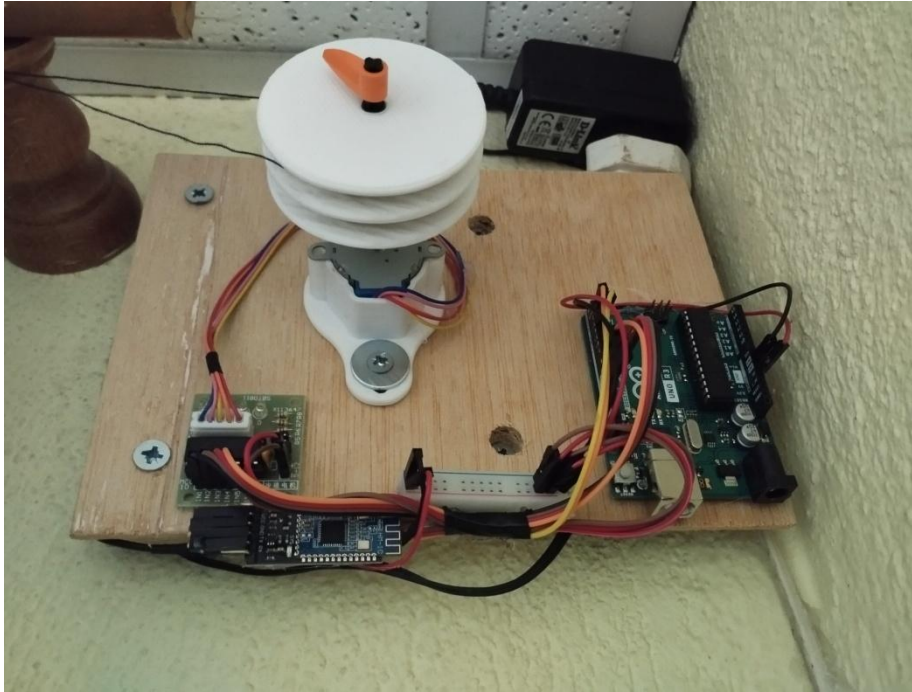
Εικόνα 11: Ολοκληρωμένη κατασκευή και τοποθέτηση του αυτοματισμού κουρτίνας.
