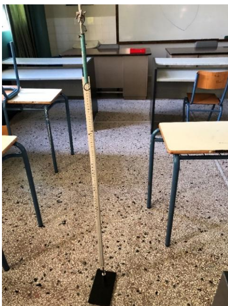
Σχήμα 3: Κοντάρι με μεζούρα, στο οποίο κρεμάστηκε το δυναμόμετρο και μετρήθηκε η επιμήκυνση με τη βοήθεια της μεζούρας
