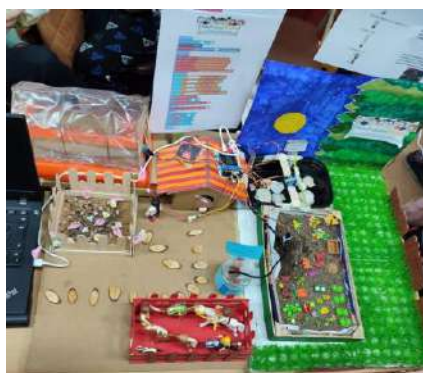
Εικόνα20. Μακέτα "Εξυπνο Αγρόκτημα" – συνδεσμολογία
